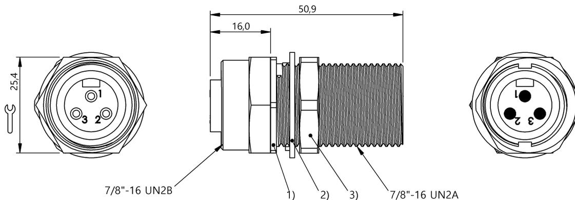
1) Стопорная гайка, 2) Уплотнительная шайба, 3) Уплотнение
